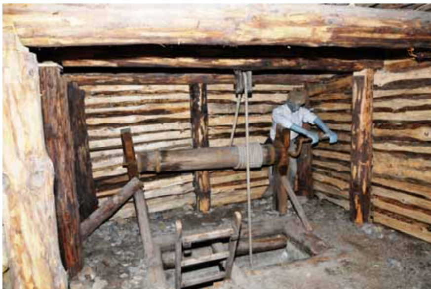
Der zweite Kursabend im Bergwerkmuseum in Zellerfeld: Ein Modell eines Harzer Bergmannes, der mit dieser Winde kleine Höhenunterschiede meistern konnte
